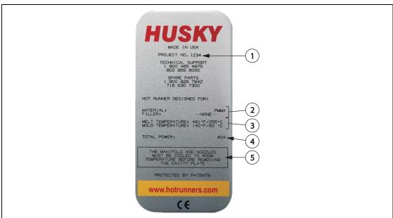
Figura 1-1 Placa de identificação da câmara quente (exemplo)
