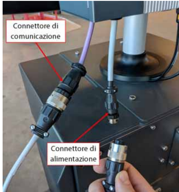
Figura 15-21 Connettori dell'interfaccia operatore
