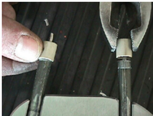
Bild 6-129: Aus- und Einbauen von PEEK-Buchsen
