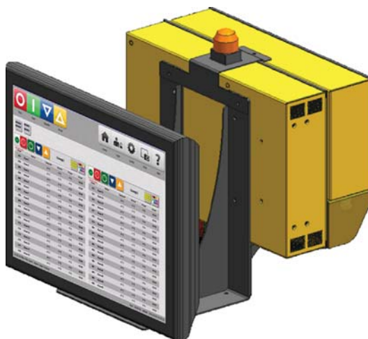
Bild 14-10 Altanium-skärmmodulen borttagen från huvudenheten.
