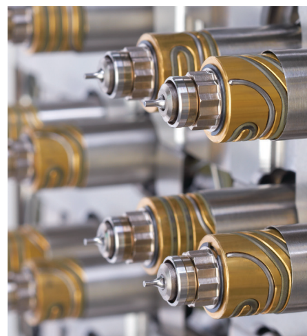
La tecnología UltraSync permite un espaciado de boquilla reducido.
