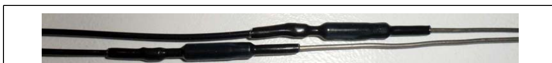
図 6-17 ナックルの配線溝への交互配置
