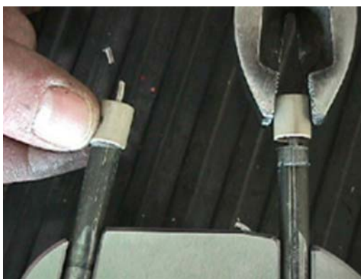
図 6-29 PEEK ブッシュの取外し / 取付け
