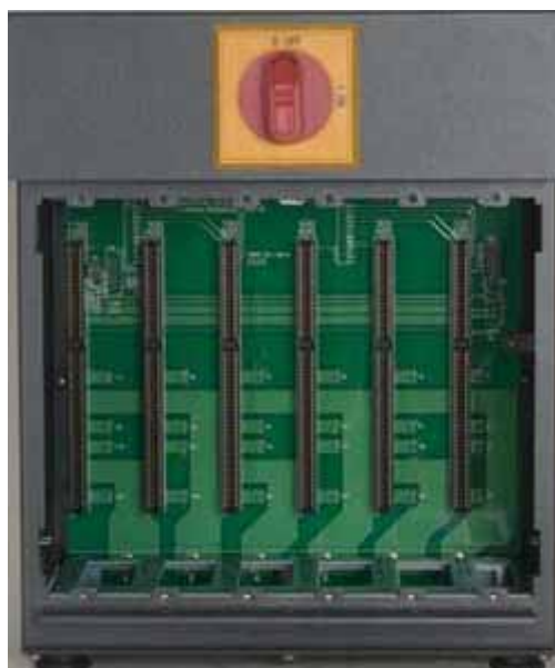
Базовый блок с открытой задней панелью
