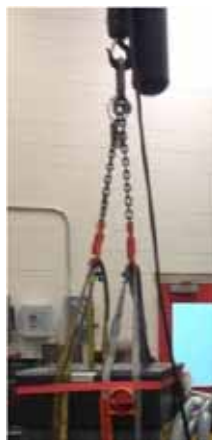
Abbildung 1-1 Befestigung von Gurten an der Hebevorrichtung
