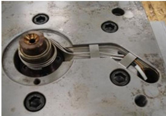
**Figura 5-23: Cable envuelto en torno a la resistencia del bebedero (ejemplo)**
