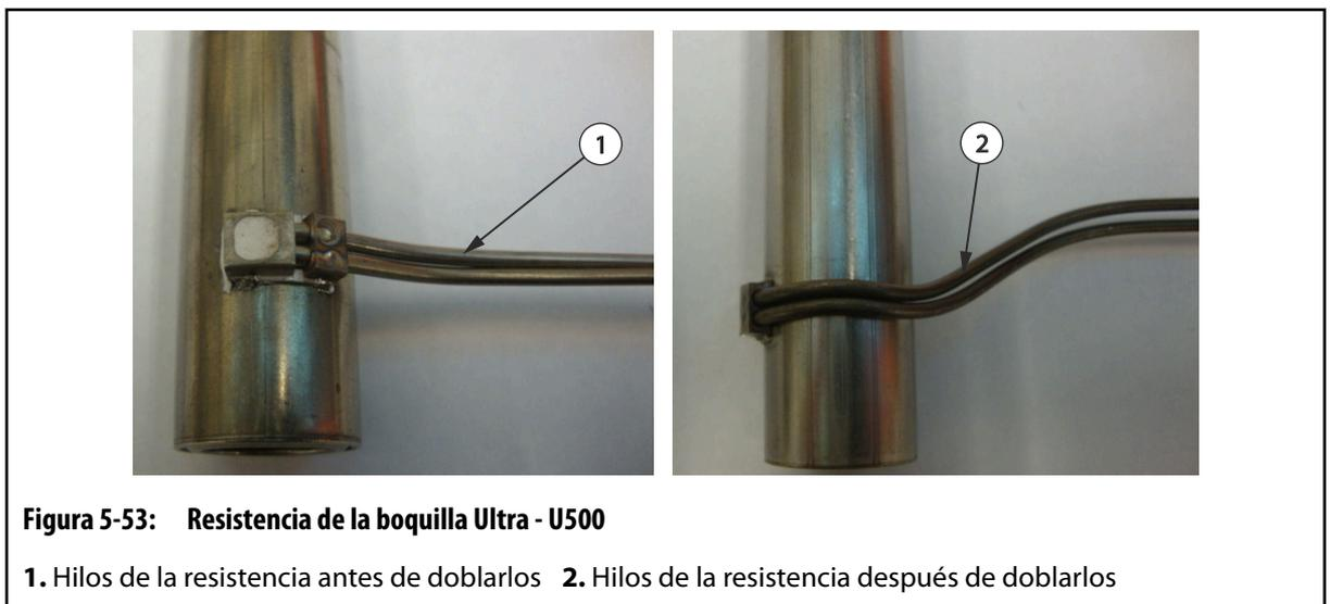
7. Dirigir los hilos del termopar y resistencia de la boquilla a través de los canales para hilos en la placa del distribuidor. Asegurarse de que todos los hilos están sujetos de manera adecuada en sus canales por medio de pinzas para cables.
