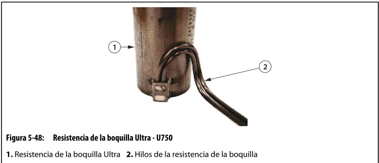
7. En las resistencias U500, primero doblar los hilos a lo largo de la curvatura de la resistencia y, a continuación, doblarlos hacia arriba o abajo (lejos del conductor salida de hilos del cuerpo de la resistencia) para asegurar que pasan por las ranuras para cables en la placa del distribuidor.
