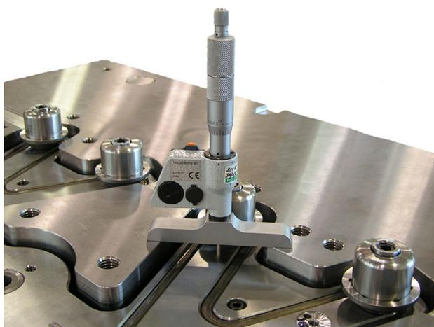
**Figura 5-17: Medición de la precarga**
