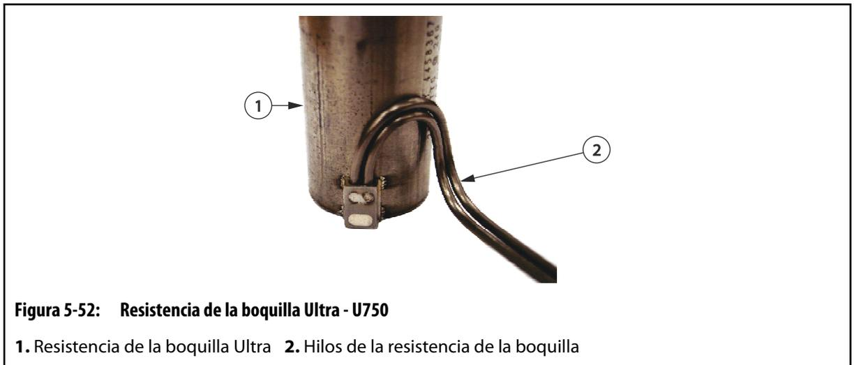
6. En las resistencias U500, primero doblar los hilos a lo largo de la curvatura de la resistencia y, a continuación, doblarlos hacia arriba o abajo (lejos del conductor salida de hilos del cuerpo de la resistencia) para asegurar que pasan por las ranuras para cables en la placa del distribuidor.
